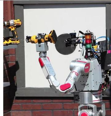
Задачи, которые приходится решать роботу на аварийной площадке: движение по гряде камней, открывание двери ключом, открывание вентиля трубопровода, управление автомобилем, высверливание портативной дрелью в стене большого отверстия перфорацией
