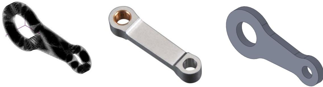
Рис. 2. Шатун, его модель и волокна в его теле
