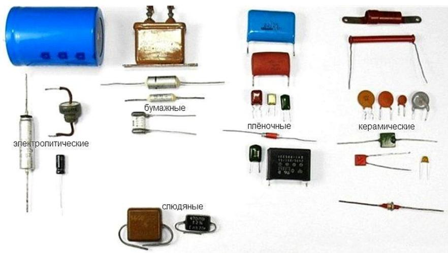
Рис. 2. Разновидности конденсаторов
